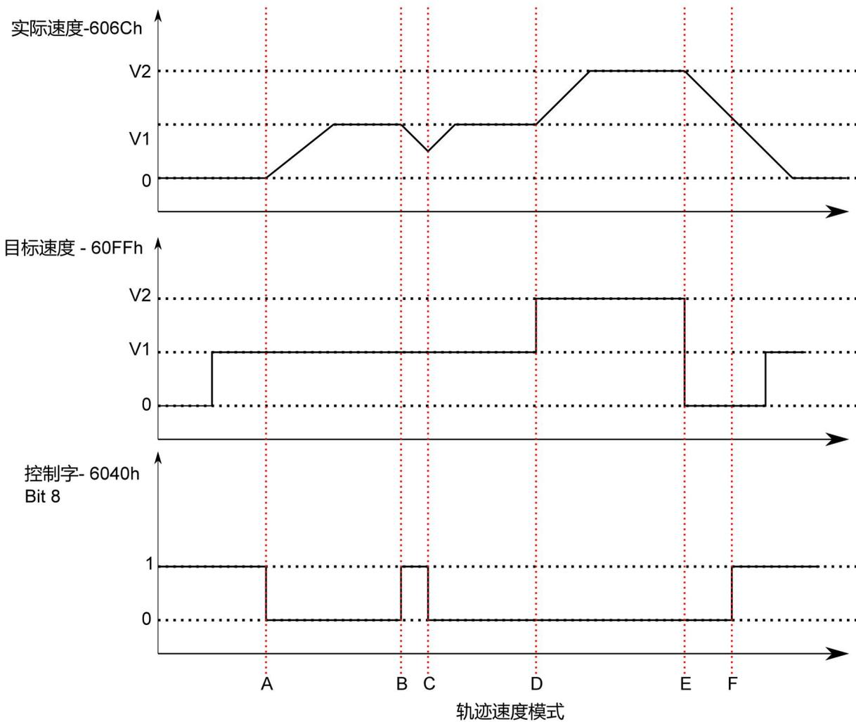
上图显示了电机运行状态，实际速度，目标速度和控制字的对应关系。
