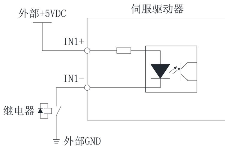
2. 当上位机为集电极开路输出时接线示意图
