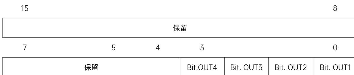
Pn107 寄存器的对应位 Bit.INx 为 1，将强制该输出端口对应的功能为有效，否则为无效(受一体机实际输出逻辑控制)。
