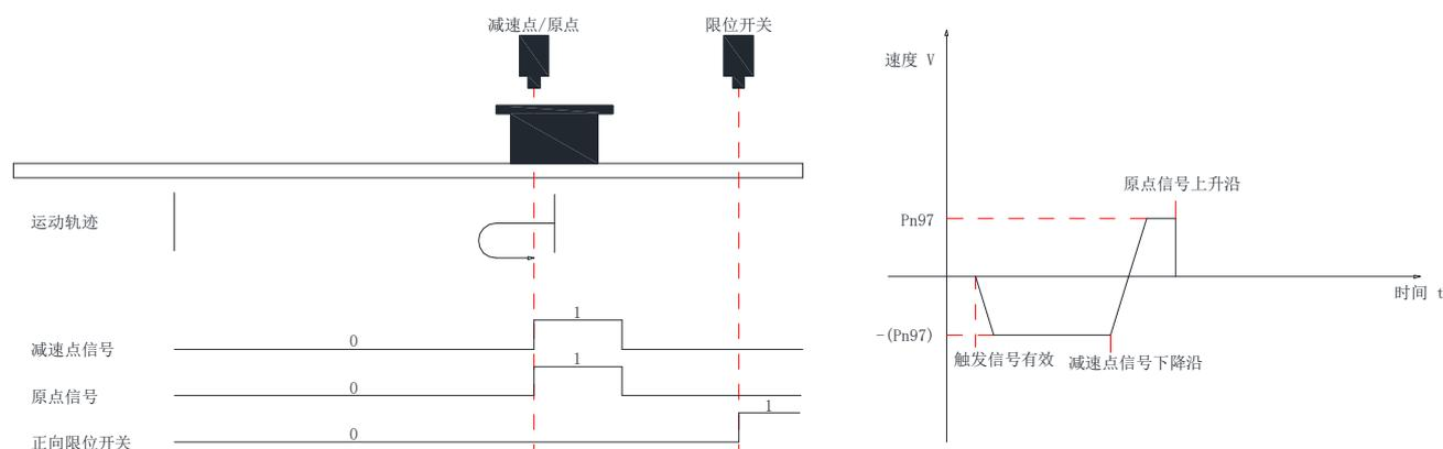
③ 电机回原点前原点开关（减速点）信号无效（0-无效，1-有效），回原点过程触发正向限位开关
