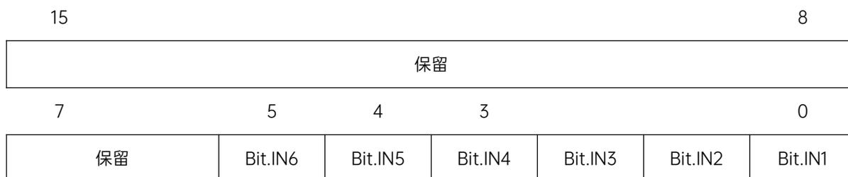
Pn106 寄存器的对应位 Bit.INx 为 1，将强制该输入端口对应的功能为有效，否则为无效(受一体机实际输入信号控制)。
