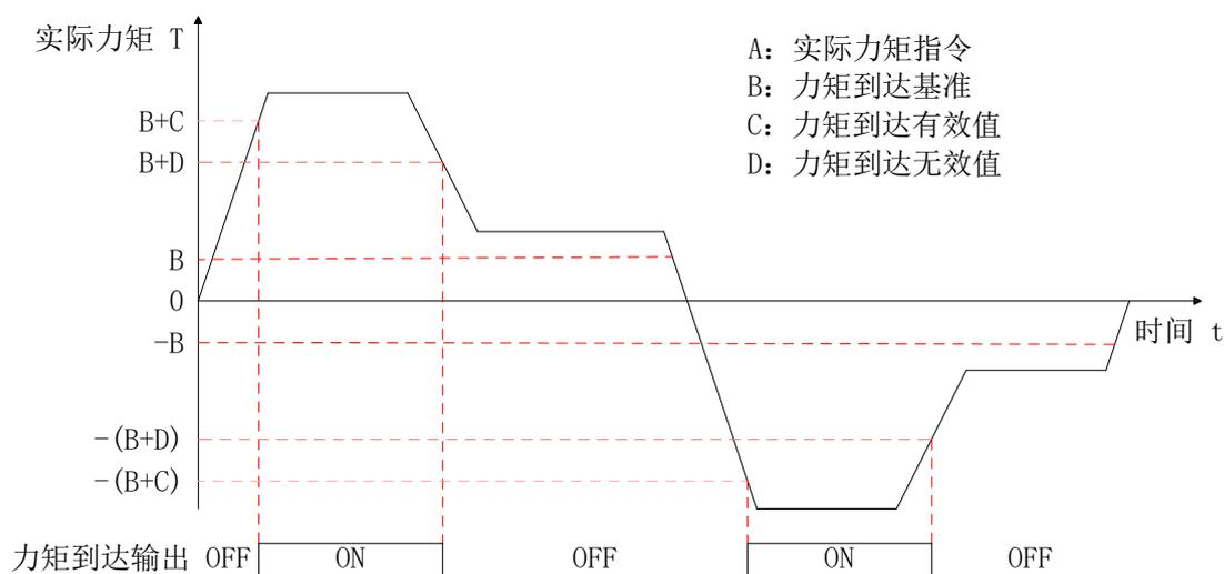
实际转矩指令（可通过通讯方式读取 Pn178 号参数值）：A
