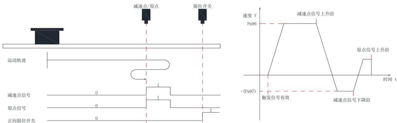
② 电机回原点前原点开关（减速点）信号有效（0-无效，1-有效），全程未触发正向限位开关
