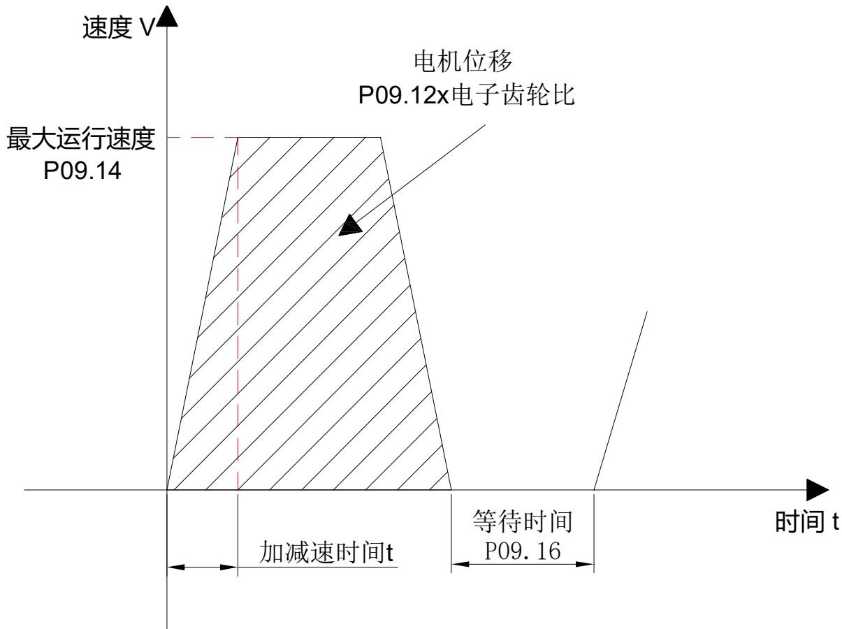
因此，实际加速到 P09.14（第 1 段位移最大运行速度）的时间  $t$ :
