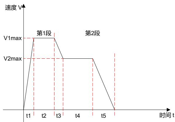
V1max、V2max: 第 1 段、第 2 段指令速度;
